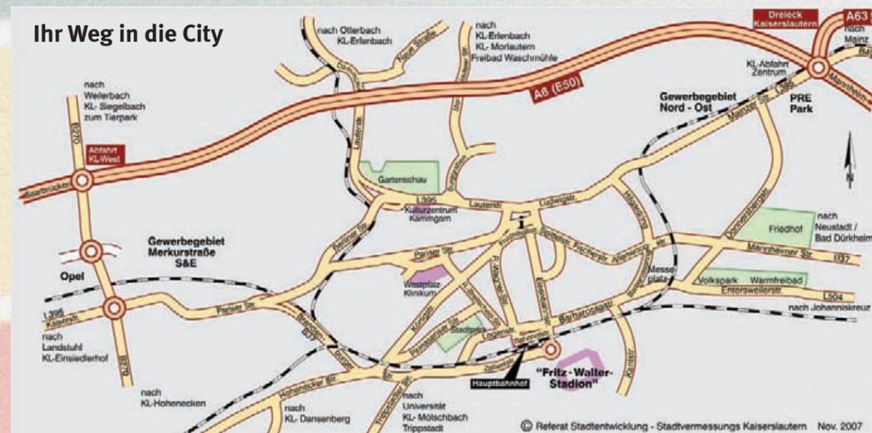
In der Innenstadt von Kaiserslautern sind alle Parkhäuser und Tiefgaragen an das dynamische Parkleitsystem angeschlossen. Dabei senden die Schrankenanlagen in den einzelnen Parkierungseinrichtungen laufend Informationen über die ein- und ausfahrenden Fahrzeuge an einen im Rathaus installierten Zentralrechner. Dieser ermittelt die jeweilige Anzahl der freien Parkplätze und meldet diese an die Wegweiser im Straßenraum. So werden Sie laufend aktuell über die Parkplatzsituation informiert.
